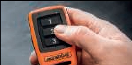
CONTROL REMOTO El control remoto personalizable permite al operador poner en marcha y parar la máquina, y hacer funcionar las correas transportadoras. Esto reduce la carga de trabajo, mejora la seguridad laboral y hace posible acciones inmediatas, como por ejemplo, detener la máquina.
