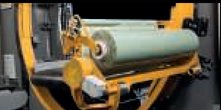
CONTROL DEL PLÁSTICO Alerta al operador si el plástico se rompe o se acaba. El control del plástico permite un funcionamiento continuo y sin problemas.
